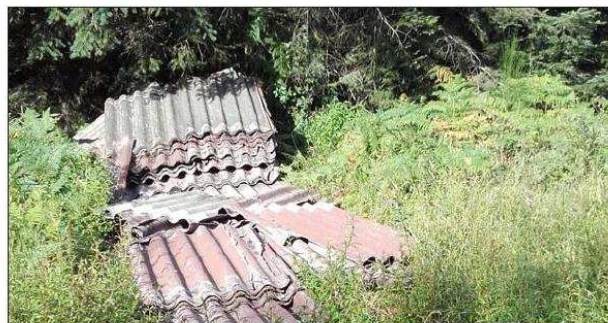
■ L'amiante est présent notamment dans les plaques de fibrociment. Photo d'illustration Annie GIRARD
